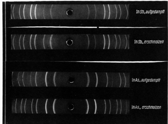
Abb. 3. RÖNTGEN-Rückstrahlaufnahmen an Schichten aufgedampfter III—V-Verbindungen.
