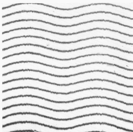
Abb. 3. Interferenzaufnahme von Ge-Kristalloberfläche mit Querriefen. In den groben Riefen (Wellen) feine Riefen. (Abdruck in H_2O eingebettet, Höhenlinienabstand = 1,7 \mu .)
